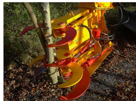
Die **Schnitt-Griffy** Modelle der Baureihe **HS 865** sind handliche, robuste Scheren mit doppelten Greifern. Die Hölzer werden von den vier Greifarmen gehalten und dann von den sich kreuzenden Messern unausweichlich umklammert und abgeschnitten. Durch die einzeln gelagerten Greifer und die gezahnte Fixierung am Rahmen ist die Haltekraft größer und somit Ihre Sicherheit deutlich verbessert.
