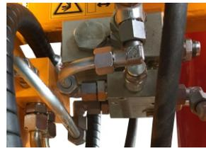
**Zusatzausrüstung Lasthalteventil mit Überlastsicherung**
