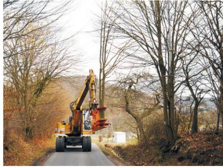
Der **Schnitt-Griffy HS 865 SE** und **HS 865** ist eine leistungsfähigere Variante unseres Modells HS 860. Die **HS 865 SE** ist eine handliche robuste Schere mit doppelten Greifern. Die Hölzer werden von den vier Greifarman gehalten und dann von den sich kreuzenden Messern unausweichlich umklammert und abgeschnitten. Durch die einzeln gelagerten Greifer und die gezahnte Fixierung am Rahmen ist die Haltekraft größer und somit Ihre Sicherheit deutlich verbessert.
