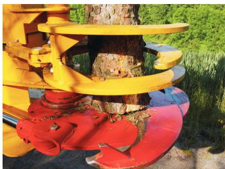
La **Schnitt-Griffy** montata su un escavatore gommato CAT 316C. In questo caso il guidatore può effettuare comodamente i suoi interventi sulla formazione legnosa, protetto dalla pioggia e dal gelo. Il nostro ultimissimo modello **HS 950** garantisce una sicurezza sul lavoro ancora più elevata grazie alle doppie coppie di pinze.
